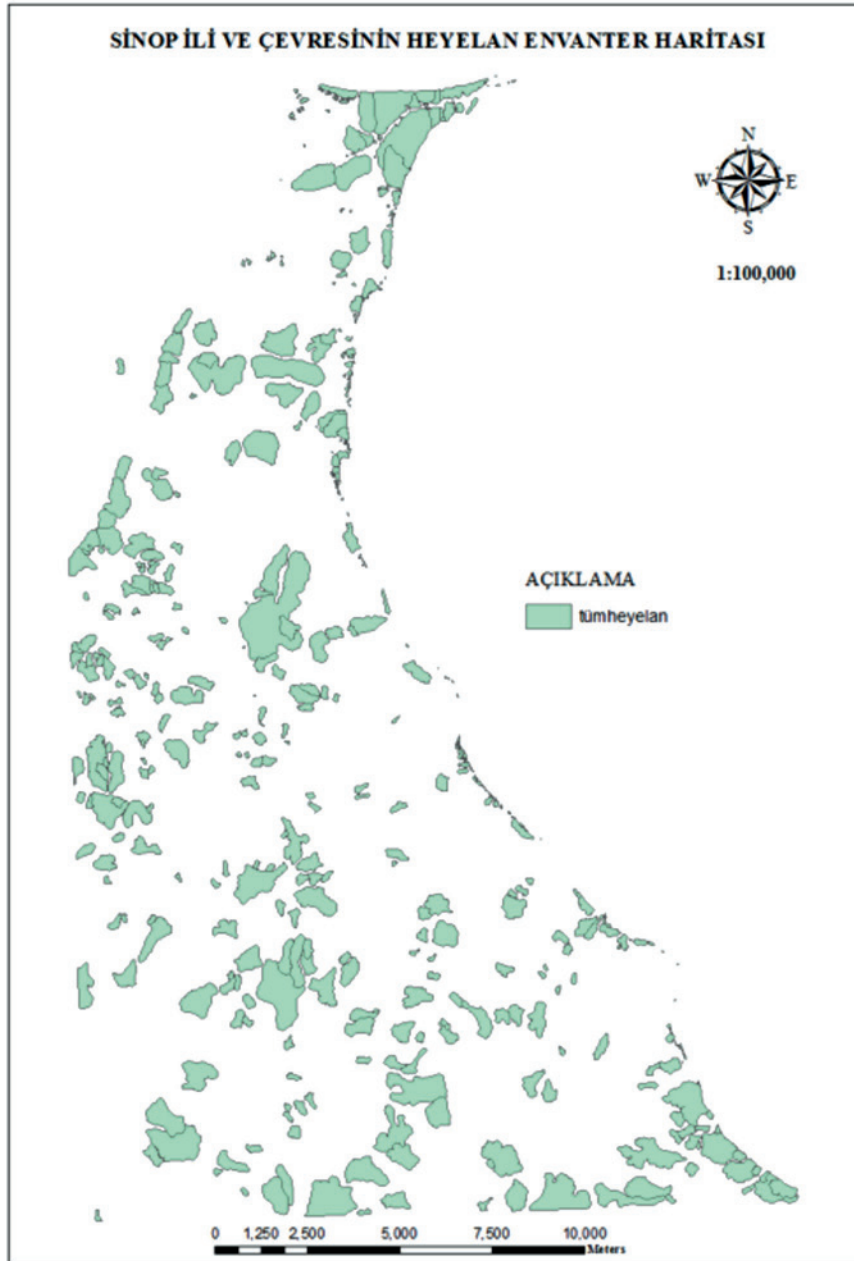
Şekil 6. Çalışma alanının heyelan envanter haritası. Figure 6. The landslide inventory maps of the study area.
